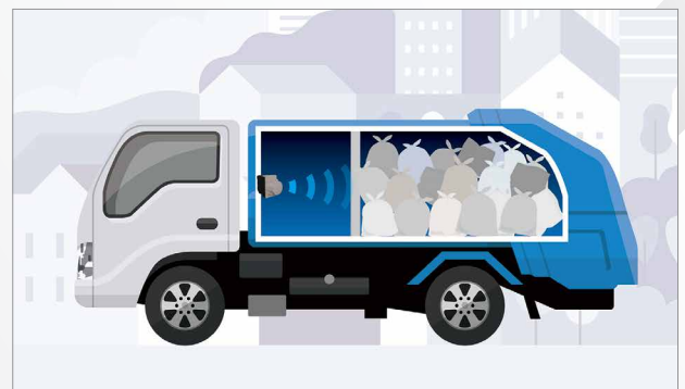
特殊車両 特殊車両のカゴ内残量・過積載を検知 過酷な環境（粉塵・ミスト）での動作物検知
