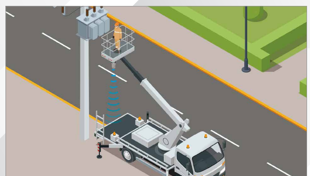
建機 特殊車両 高所作業車でのバスケット位置検知 天候を問わず位置検知が可能
